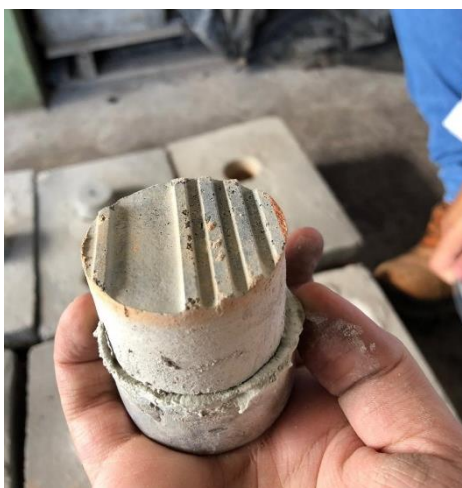
Figura 13 – Ensaio de arrancamento Fonte: Próprio autor (2019).
