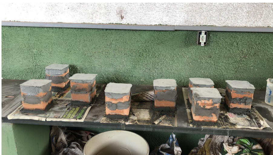
Figura 6 - Bloco solo-cimento capeamento Fonte: Próprio autor (2019).
