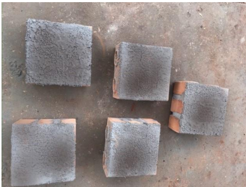
Figura 10 - Blocos solo-cimento com chapiscos umedecidos Fonte: Próprio autor (2019).
