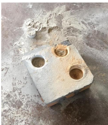
Figura 14 – Bloco solo-cimento arrancamento Fonte: Próprio autor (2019).
