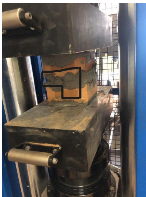
Figura 7 - Ruptura do bloco solo-cimento Fonte: Próprio autor (2019).
